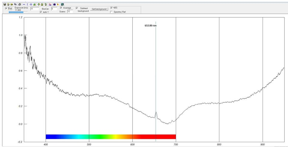
Absorption UV-VIS-PIR du zircon rose de Harts Range. Léger pic à 653 nm.
